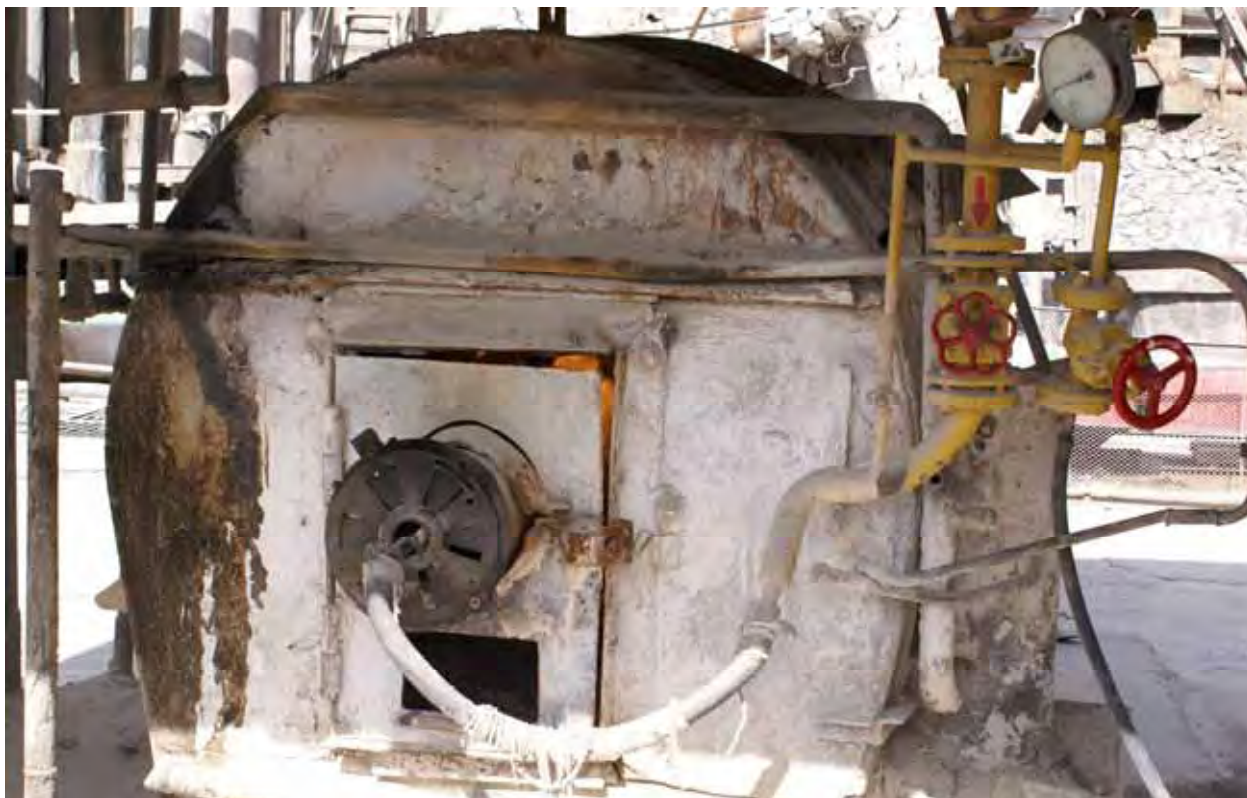
Рис. 21 Горелка (пригодный газ) барабанной печи
